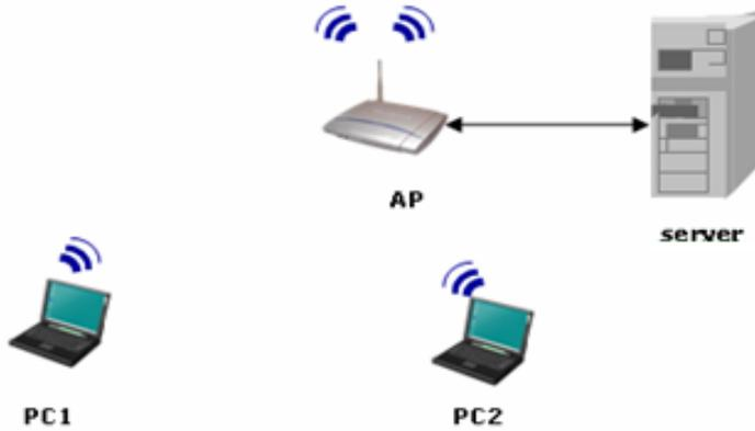
الشكل (13) مخطط شبكة WLAN ذات نظام التوزيع العملية المخبرية
